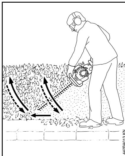
Heckenschere bogenförmig von unten nach oben führen – absenken und weitergehen – und die Heckenschere wieder bogenförmig nach oben führen.
